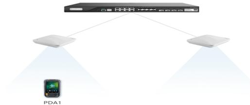
工业零漫游部署：多台物理AP虚拟成一台大的“虚拟AP”，达到“零漫游”效果，生产业务连续不中断
