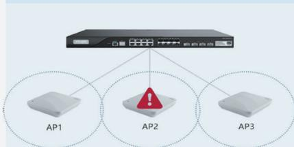
无线设备故障时，留下射频空洞及时发现射频空洞，自动进行AP功率调整，实现秒级调整，不影响业务使用
