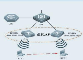
多台AP虚拟成一台大的“虚拟AP”，终端一直认为关联在同一台AP上，达到零漫游效果，锐捷可实现千分之一的丢包率
